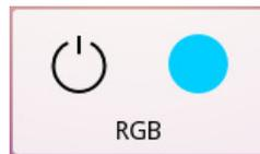
La función del botón de acción se configura a través del parámetro *Función del botón izquierdo*: bien apagar todos los canales (poner todos los canales al 0 %), o bien conmutar entre apagar todos los canales y recuperar el color previamente seleccionado.
